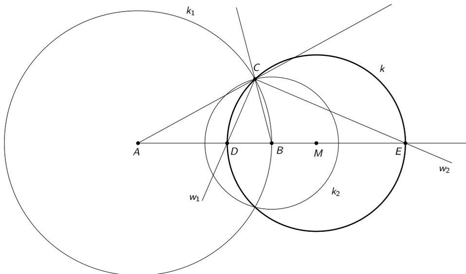
Abbildung 1: geometrische Konstruktion mit Hilfe der Winkelhalbierenden für  $v = \frac{a}{b} = \frac{1}{2}$
