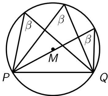
Die Randwinkel  $\beta$  eines Kreises über derselben Sehne  $PQ$  sind nach dem Peripheriewinkelsatz gleich groß.
